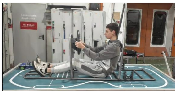
Pruebas realizadas in situ para determinar la posición definitiva del asiento, volante y retrovisores
