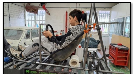
Pruebas realizadas in situ para determinar la posición definitiva del asiento, volante y retrovisores
