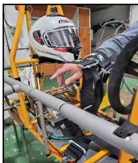
Pruebas realizadas in situ para determinar la posición definitiva del asiento, volante y retrovisores
