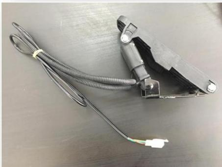
Se ubicará **en la parte delantera del vehículo**, a la altura de los pies del piloto, de forma que la posición del pie derecho sea cómoda durante toda la carrera. El cableado que une el acelerador con la controladora se conduce por el lado derecho del chasis como se puede apreciar en la imagen del **punto 3.1** de este desafío.
