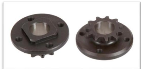
**Coronas traseras intercambiables**, intercambiables sin desmontar el eje, mediante dos sistemas:
