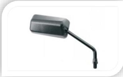
Los **retrovisores** serán de 112x57, suficiente para tener una visibilidad aceptable y ofrecer poca resistencia aerodinámica. Irán anclados al arco delantero a unos 100 mm por debajo de la altura de los ojos del piloto.
